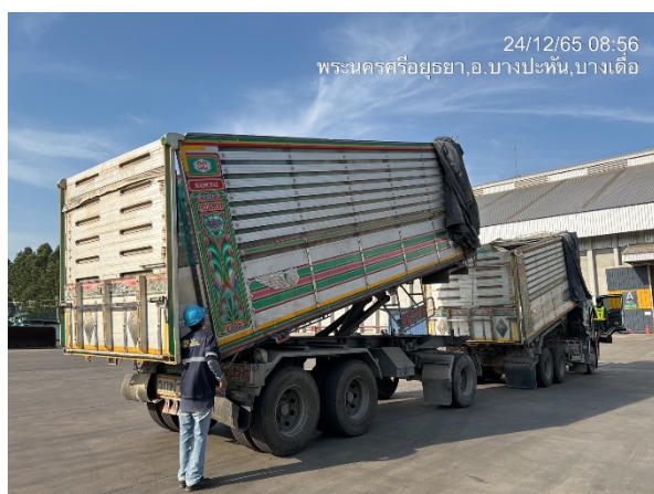
รูปที่ 2.2-36 การตรวจสอบความเรียบร้อยของกระบะรถบรรทุกอยู่เสมอ เช่น การใช้ผ้าใบคลุมรถทุกครั้ง การตรวจสอบความสะอาดของกระบะรถบรรทุก ก่อนออกนอกโครงการ เพื่อป้องกันเศษวัสดุตกหล่นบนถนนและป้องกันการเกิดฝุ่นละออง
